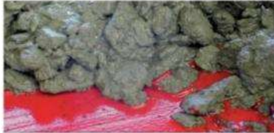
zwischen Holz und Beton ergibt sich ein starrer Verbund
