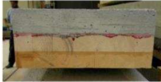
Das Fertigteil wird im nass-in-nass-Verfahren hergestellt
