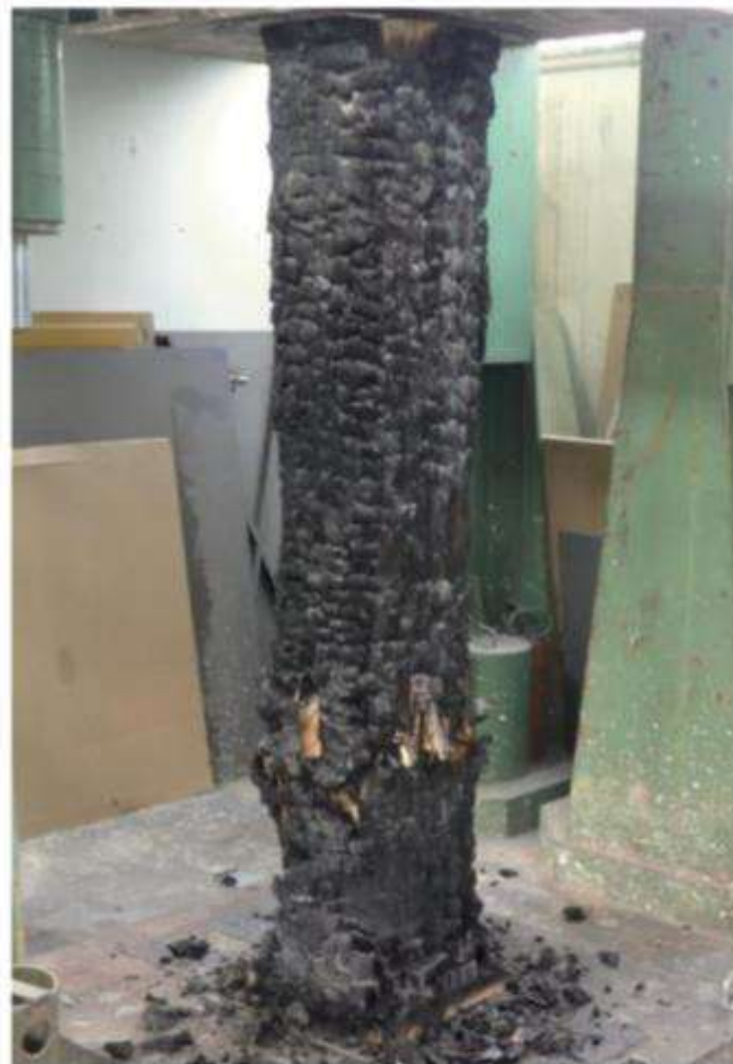
Bild 2: Versagensbild (Schubversagen Holzfaser)
