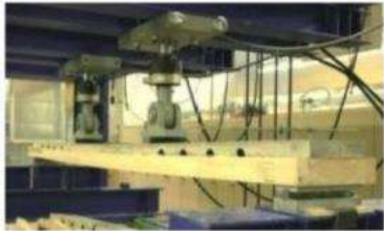
zwischen Holz und Beton ergibt sich ein starrer Verbund
